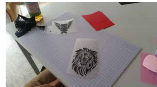
Die gewünschten Motive werden mit dem Schneidplotter aus der Folie ausgeschnitten
