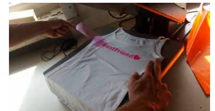
Mit der Transferpresse werden die Motive auf die Kleidung übertragen
