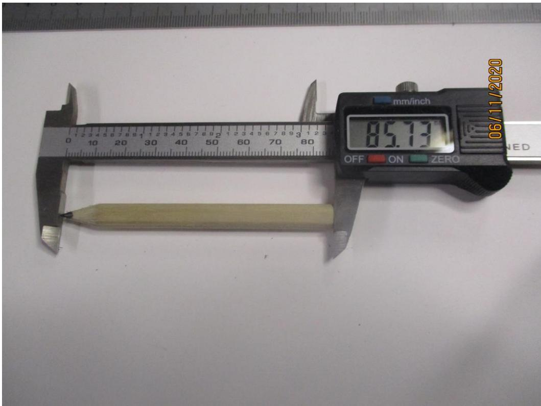
Auf dem Bild haben wir den Bleistift vor aufmalen der Linien gemessen. Das ist der original Bleistift unbenutzt mit einer Länge von 85,73mm.
