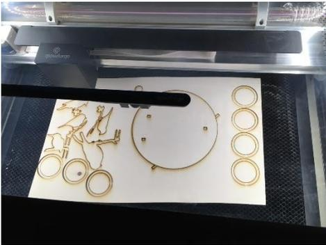
Mit dem Programm **Inkscape** kannst du eine Vogelfutterschaukel entwerfen, die anschließend mit dem **Laserschneider** aus Sperrholz ausgeschnitten und dann zusammengesetzt wird. So entstehen Vogelfutterschaukeln die du am Balkon aufhängen kannst, um den Vögeln in der kalten Jahreszeit Futter anzubieten.
